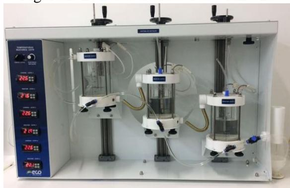
Após verificou-se a posição das válvulas para direcionar a água para as camisas, estas foram utilizadas a fim de manter a temperatura uniforme para que esta não influenciasse no resultado, em seguida os reatores foram conectados em série. Foi acionada a bomba peristáltica a uma vazão constante, posteriormente regulando altura entre os reatores foi possível igualar os níveis de água em 400 ml, após os agitadores foram ligados para promover a mistura completa no interior dos reatores.
