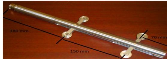
Figura 2: Corpo da sonda.
