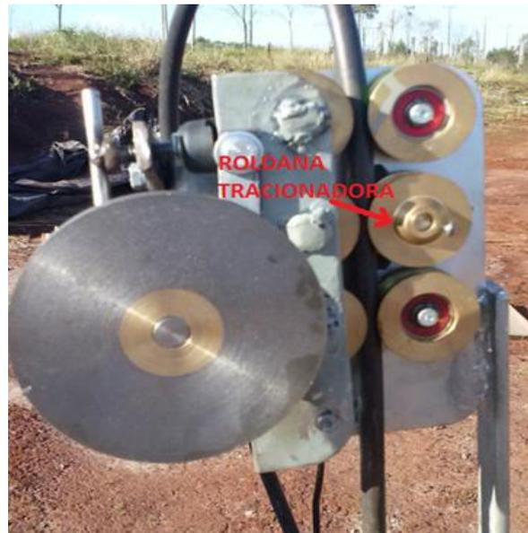
Figura 7: Dispositivo de medição de profundidade.
