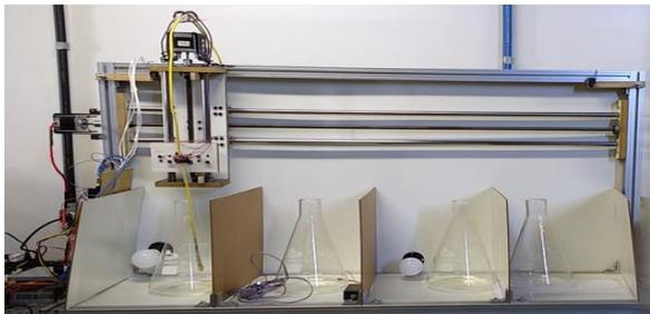
Figura 3: Controlador de microalgas para um conjunto de amostras
