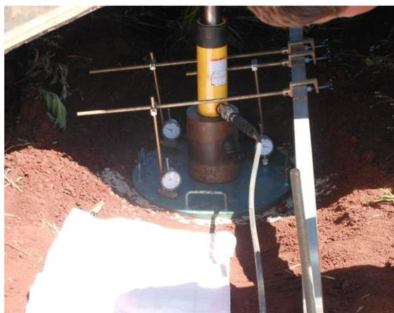
Figura 1. Ensaio de placa
