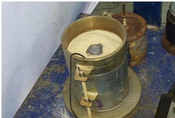
Figura 2. Preenchimento do molde e instalação da célula
