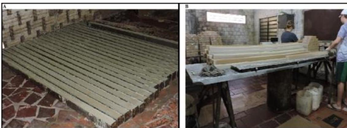
Figura 1. Partes do processo de fabricação do sabão. (A) Sabão nas formas; (B) Processo de corte e embalagem.
