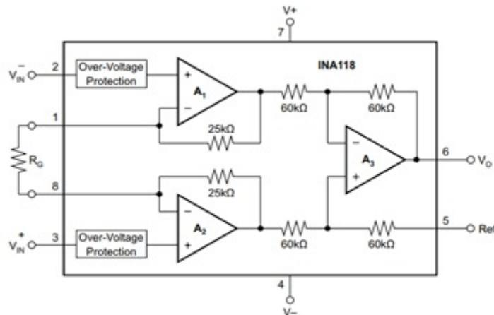
Figura 2: circuito esquemático INA118
