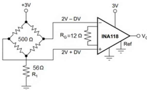
Figura 3: Ponte Wheatstone conectada ao INA118
