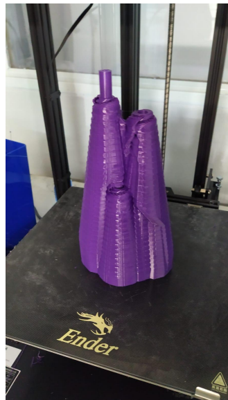
Figura 1 - Impressão das barras roscadas dentro de suportes auxiliares de sustentação
