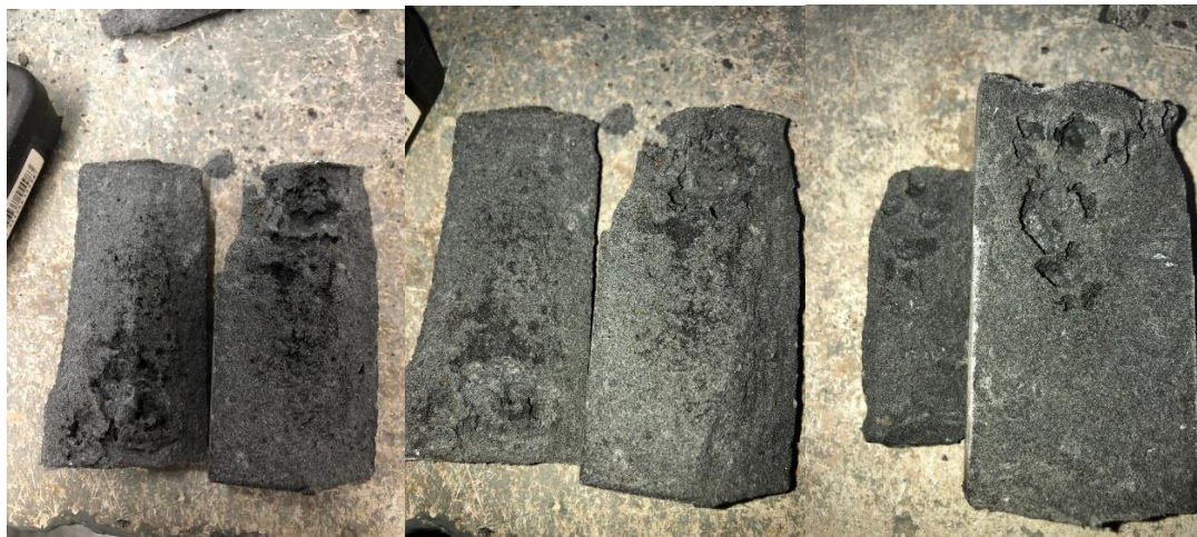
Figura 1: Interior dos corpos de prova após seu rompimento.
