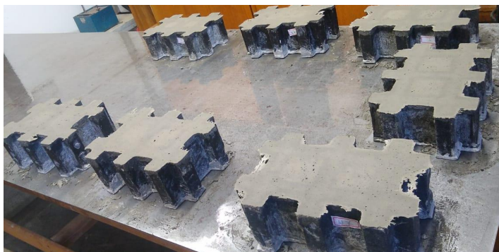
Figura 4: Regularização dos blocos
