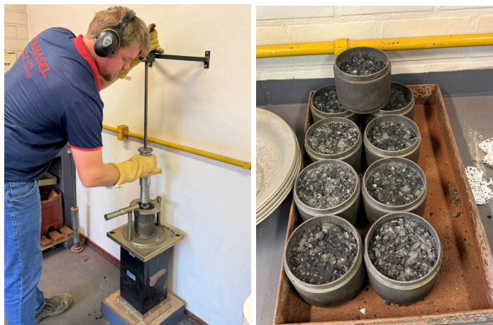
Figuras 1 e 2 - Compactação Marshall dos corpos de prova e moldes cilíndricos preenchidos com CBUQ.
