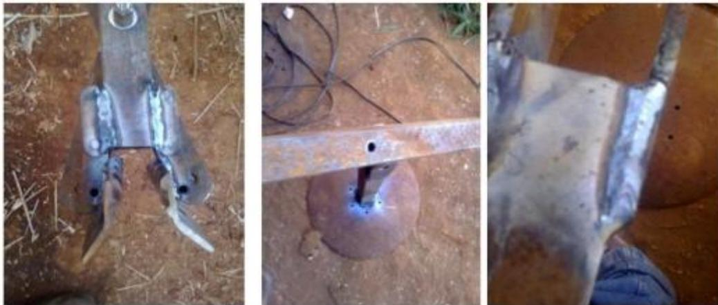
Figura 2 – Fotografias do protótipo construído da ferramenta para auxílio no processo de arrancar mandioca.
