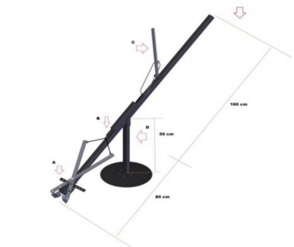
Figura 1 – Projeto da ferramenta para auxílio no processo de arrancar mandioca.
