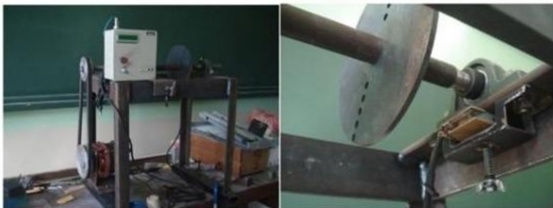
Figura 3. Protótipo Experimental do Balanceador de Eixos e Detalhes de Instalação do Sensor Piezoelétrico
