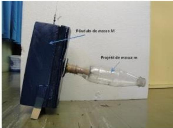
Imagem 02: Projétil acoplado ao pêndulo.
