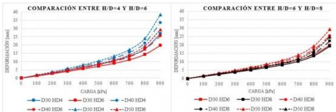
Figura 2: Resultados de carga-deformación obtenidos.
