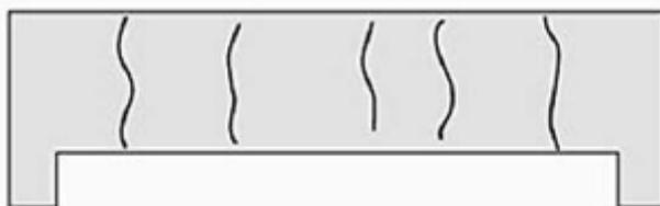
Figura 1 - Trincas no concreto por retração hidráulica (MARCELLI, 2007).
