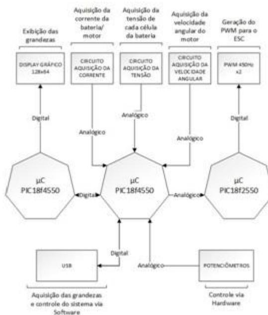
Figura 3: Esquema do console de aquisição e tratamento de dados.
