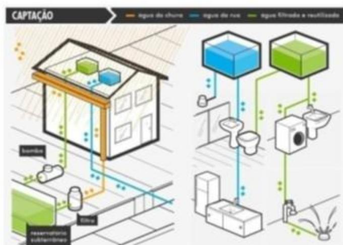
Figura 1: Sistema de captação da água das chuvas
