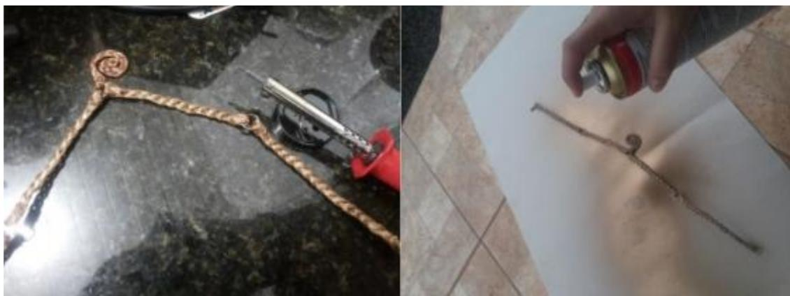
Figura3 - Processo de solda e tintura da trama de fio de cobre. / Fonte: Elaborado pelo autor (2016).
