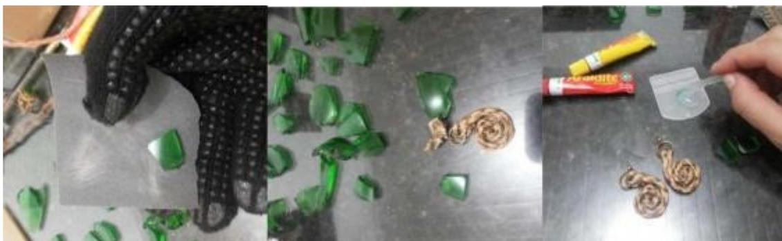
Figura4 - Lixamento do vidro e colagem dele na peça de cobre. / Fonte: Elaborado pelo autor (2016).
