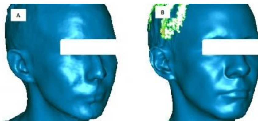
Figura 2. Comparativo entre digitalizações: Kinect (A) e Artec (B)
