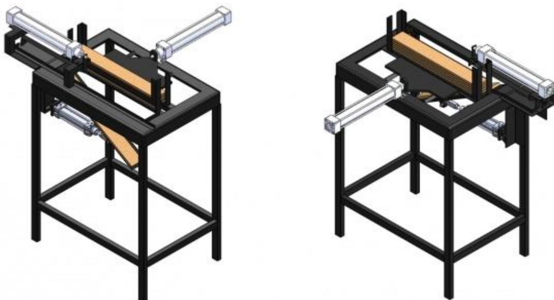
Figura 4: Modelo sólido computacional da bancada alimentadora de peças em vistas isométricas.
