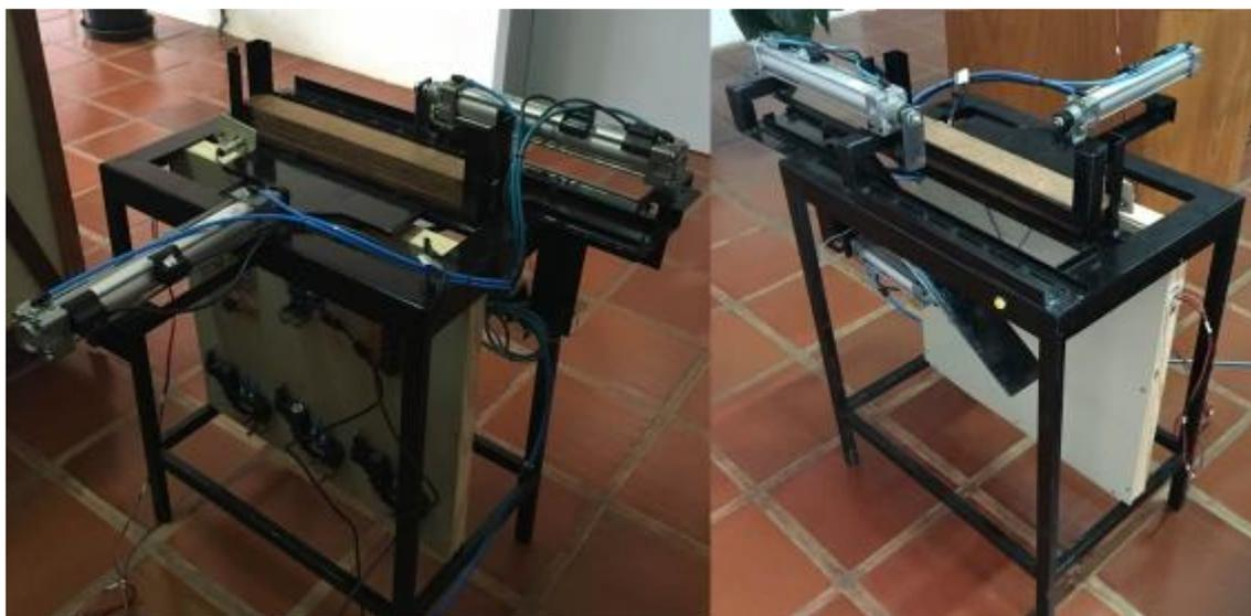
Figura 5: Protótipo da bancada alimentadora de peças.
