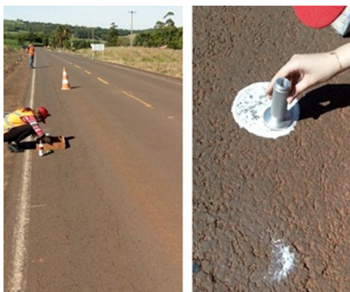
Figura 3: Realização dos ensaios de mancha de areia na rodovia.
