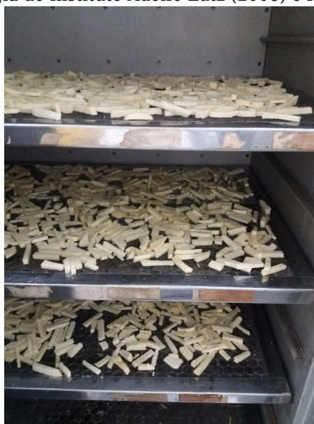
Figura 1 - Foto ilustrativa da estufa de circulação e renovação de ar utilizada para a desidratação de batata-doce.
