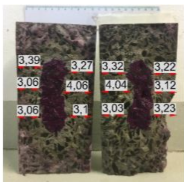
Figura 6a - Profundidade de carbonatação no concreto referência, A/C: 0,469 (Autoria própria, 2017)
