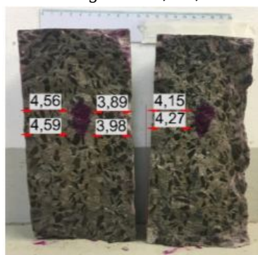
Figura 6b - Profundidade de carbonatação com 20% de substituição do agregado miúdo, A/C: 0,477 (Autoria própria, 2017)
