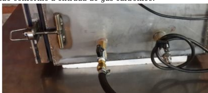
Figura 4 - Válvula de entrada de gás carbônico (Autoria própria (2017))
