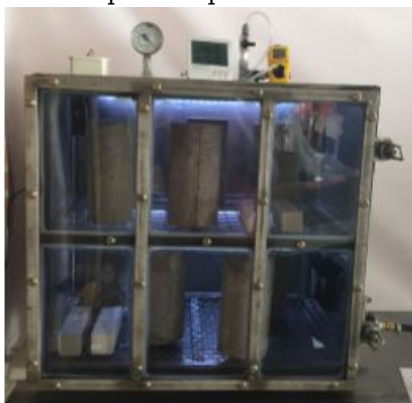
Figura 1 - Câmara de carbonatação acelerada feita em laboratório (Autoria própria (2017))
