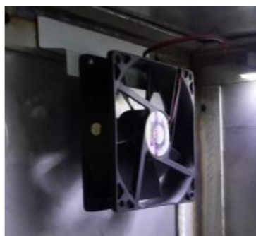
Figura 3 - Coolers Internos (Autoria Própria (2017))
