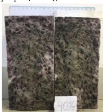
Figura 6c - Profundidade de carbonatação com 40% de substituição do agregado miúdo, A/C: 0,515 (Autoria própria, 2017)
