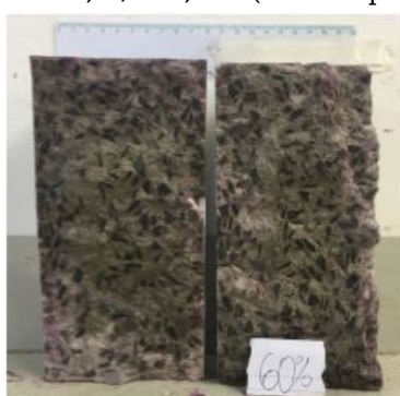
Figura 6d - Profundidade de carbonatação com 60% de substituição do agregado miúdo, A/C 0,567 (Autoria própria, 2017)
